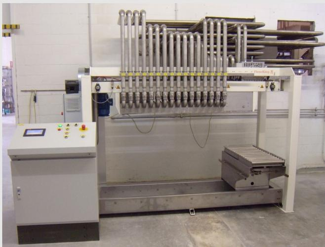
可動式計量器による32品目の重量式充填装置。すべてのコンポーネントは、固定タンクと交換可能なIBCコンテナに配管で接続されています。
